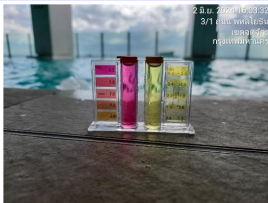
รูปที่ 3-19 เครื่องมือสำหรับตรวจวิเคราะห์คุณภาพน้ำ ประจำสระว่ายน้ำ
