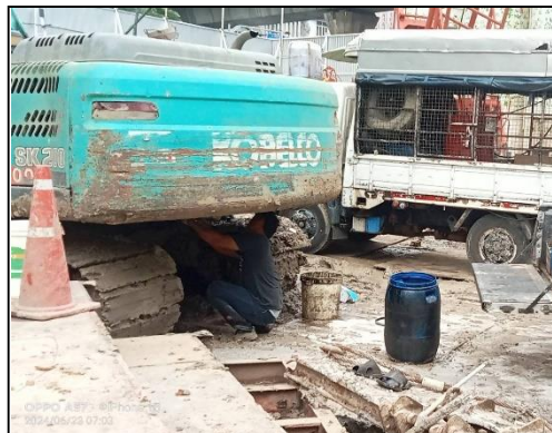
ภาพที่ 22 ใช้น้ำมันหล่อลื่นช่วยลดการเสียดสีของเครื่องจักร
