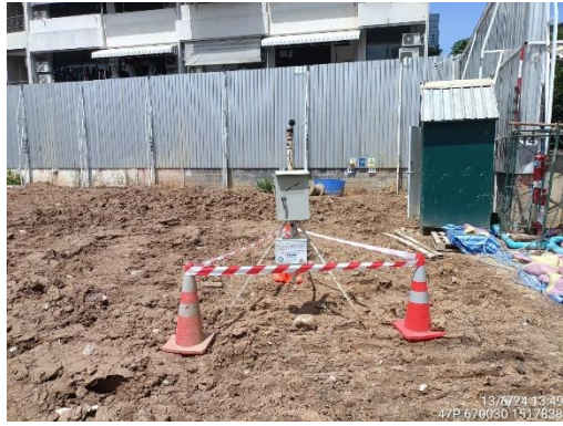
รูปที่ 16 ติดตั้งเครื่องตรวจวัดคุณภาพสิ่งแวดล้อม
