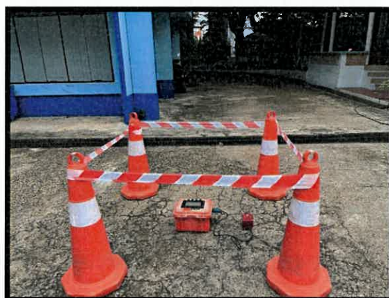
รูปที่ 4.3.3-2 แสดงการตรวจวัดความสั่นสะเทือน (บริเวณโรงเรียนดาราคาม)
