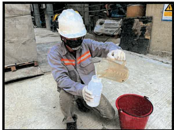
รูปที่ 4.3.4-8 แสดงการเก็บตัวอย่างน้ำทิ้ง บริเวณบ่อกักน้ำทิ้งก่อนปล่อยออกนอกโครงการ
