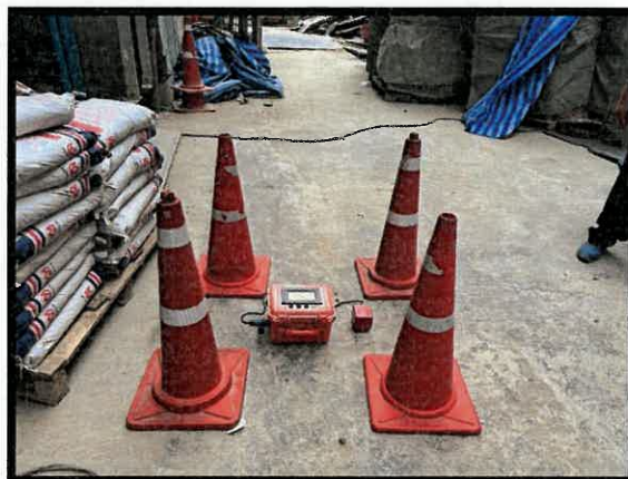
รูปที่ 4.3.3-1 แสดงการตรวจวัดความสั่นสะเทือน (บริเวณพื้นที่โครงการ)
