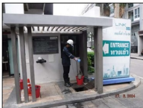
(5) บ่อพักน้ำสุดท้ายก่อนปล่อยออก
