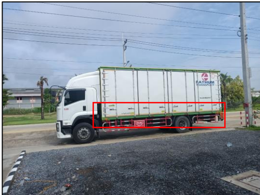
รูปที่ 2-26 การติดแผ่นสะท้อนแสงบริเวณด้านข้างรถบรรทุก
