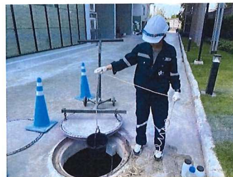
รูปที่ 3.1-3 จุดตรวจวัดคุณภาพน้ำทิ้งก่อนระบายออกนอกโครงการ (บ่อตรวจสอบภาพน้ำ) ประจำเดือนมกราคม - มิถุนายน 2567
