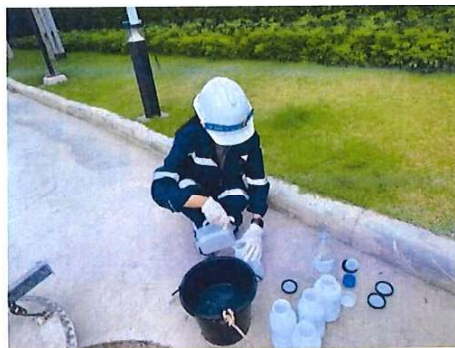
รูปที่ 3.1-3 จุดตรวจวัดคุณภาพน้ำทิ้งก่อนระบายออกนอกโครงการ (บ่อตรวจสอบภาพน้ำ) ประจำเดือนมกราคม - มิถุนายน 2567
