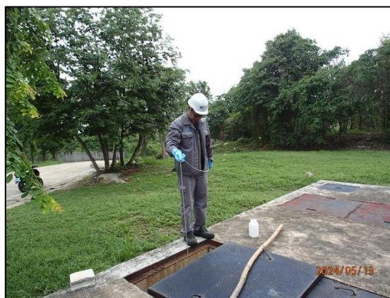
รูปที่ 3.1 การเก็บตัวอย่างคุณภาพน้ำทิ้ง บริเวณ บ่อพักน้ำทิ้งก่อนระบายออกนอกโครงการ
