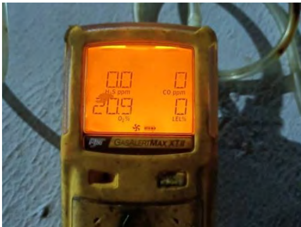
ตรวจวัดคุณภาพอากาศขณะปฏิบัติงาน - ก่อนล้างทำความสะอาด
