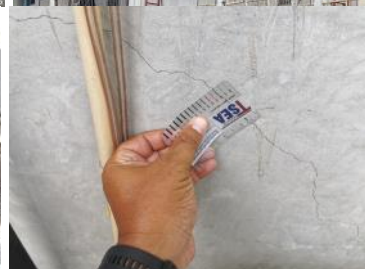
รูปที่ ๗7.21 การสำรวจ/ถ่ายภาพสภาพรั้ว กำแพงบ้าน และตัวอาคารก่อนก่อสร้าง (ในช่วงก่อสร้าง)
