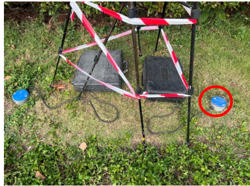
รูปที่ 3.21 การตรวจวัดความสั่นสะเทือน บริเวณทิศเหนือพื้นที่โครงการ
