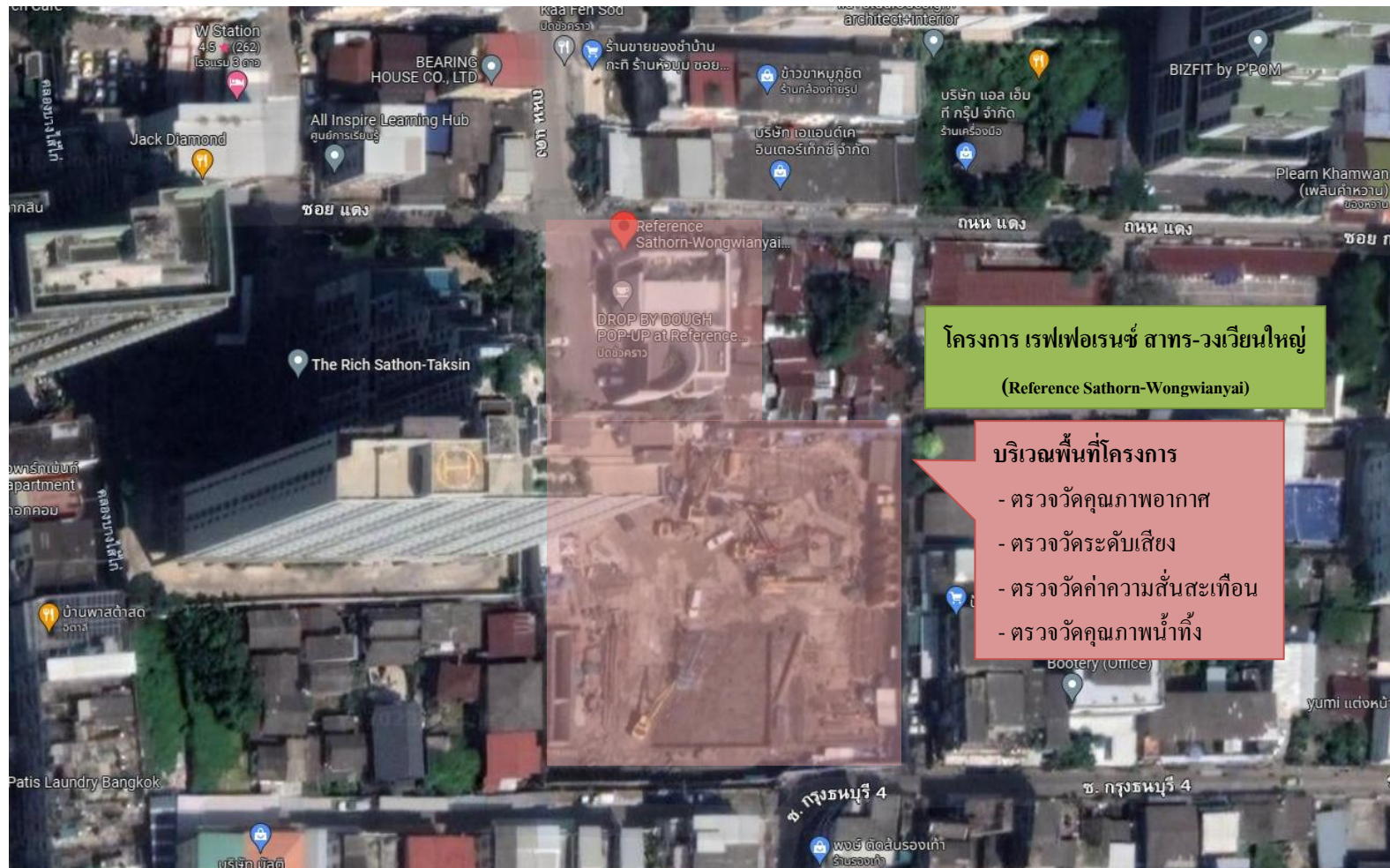
รูปที่ 4.2 ตำแหน่งการติดตั้งเครื่องมือตรวจวัดคุณภาพสิ่งแวดล้อม
