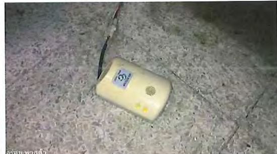
รูปที่ 2.46 ทดสอบ gas detector ภายในร้านพาสต้า
