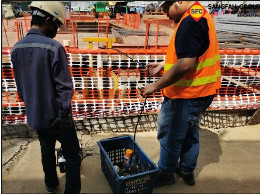
ภาพที่ 33 ติดตั้งเครื่องมือวัดการเคลื่อนตัวของดิน
