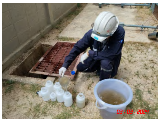
บ่อตรวจคุณภาพน้ำหลังออกจาก ระบบบำบัดน้ำเสียโครงการ ชุดที่ 1
