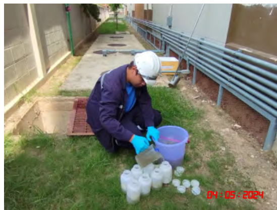
บ่อตรวจคุณภาพน้ำหลังออกจาก ระบบบำบัดน้ำเสียโครงการ ชุดที่ 2
