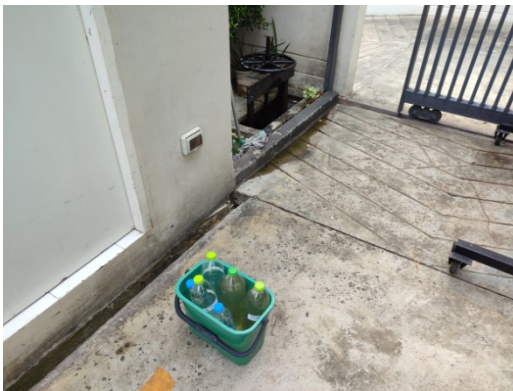
เก็บตัวอย่างน้ำที่บ่อตรวจสอบคุณภาพน้ำทิ้ง
