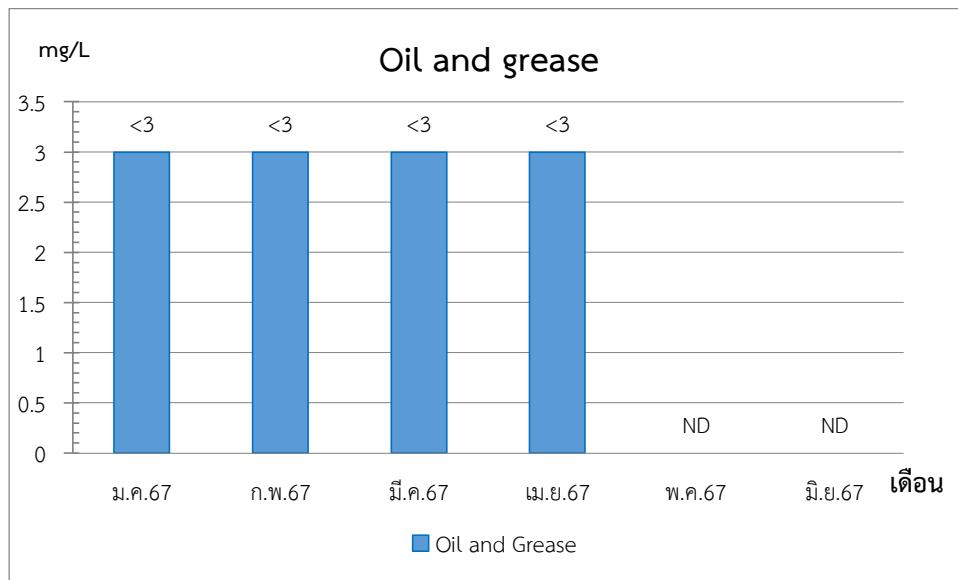
รูปที่ 3.16 กราฟแสดงผลการตรวจวิเคราะห์ Oil and grease จุดที่ 1 คุณภาพน้ำเสียก่อนการบำบัด บริเวณบ่อเติมอากาศแบบต่อเนื่อง
