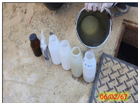
จุดเก็บน้ำหลังผ่านระบบบำบัดน้ำเสียประจำ อาคาร 6
