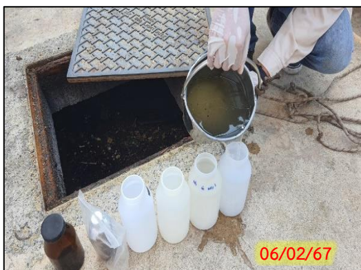
จุดเก็บน้ำก่อนเข้าระบบบำบัดน้ำเสียประจำ อาคาร 6
