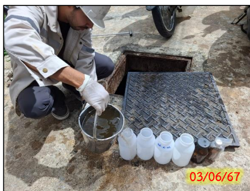
จุดเก็บน้ำก่อนเข้าระบบบำบัดน้ำเสียประจำ อาคาร 2
