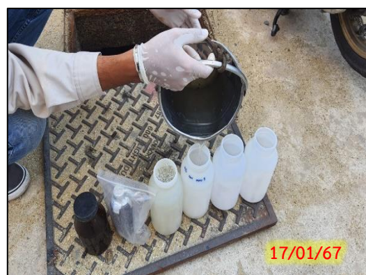
จุดเก็บน้ำหลังผ่านระบบบำบัดน้ำเสียประจำ อาคาร 7
