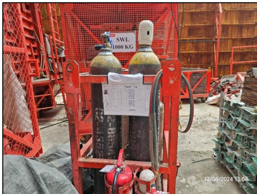
รูปที่ 31 พื้นที่วางวัตถุกั้นไฟ หรือสารเคมีให้เป็นสัดส่วนพร้อมติดป้ายเตือนอย่างชัดเจน
