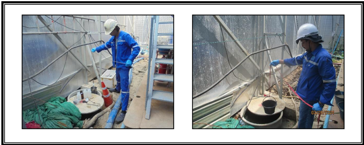
รูปที่ 3.4-1 จุดตรวจวัดคุณภาพน้ำทิ้ง บริเวณถังบำบัดน้ำเสียสำเร็จรูปในพื้นที่ก่อสร้าง
