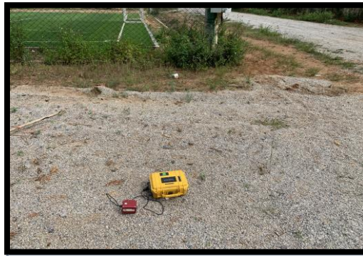
ภาพถ่ายที่ 2-25 การตรวจวัดแรงสั่นสะเทือน บริเวณบ้านดอนซอ
