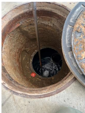
รูปที่ 3.29 ภาพแสดงการเก็บตัวอย่างน้ำจุดที่ 3 คุณภาพน้ำก่อนการบำบัด บ่อเกรอะของระบบบำบัดน้ำ เสีย
