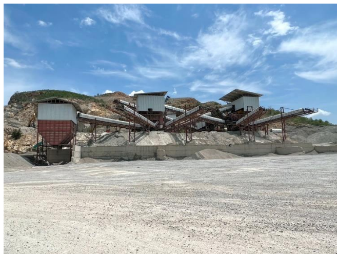
รูปที่ 2-16 โรงโม่หินของโครงการมีการจัดทำเป็นระบบปิด
