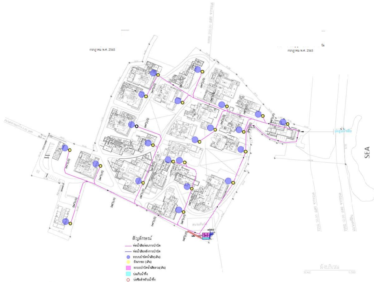
รูปที่ 3.1-2 ผังระบบน้ำเสียของโครงการ ที่มา : บริษัท กรีน เอ็นไว เอ็นจิเนียริง จำกัด, 2567
