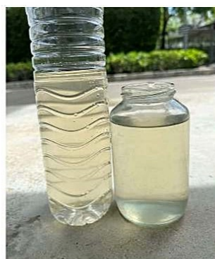
Eff. Tank น้ำทิ้งมีตะกอนขุ่น
