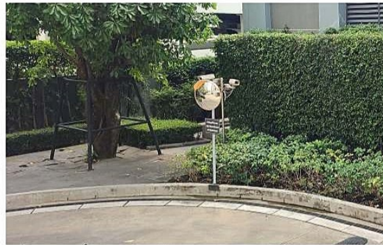
ภาพที่ 3-11 ติดตั้งกระจกุน้ำโค้งและกัล้องวงจรปิดบริเวณจุดอับสายตา
