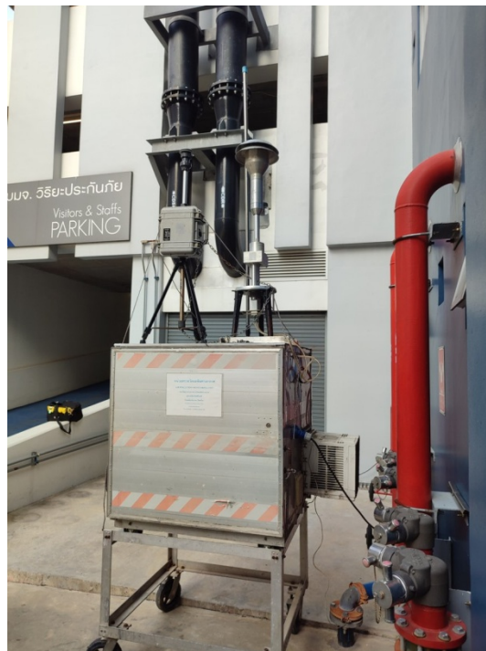
ภาพที่ 6 เก็บตัวอย่างคุณภาพอากาศภายในพื้นที่โครงการ
