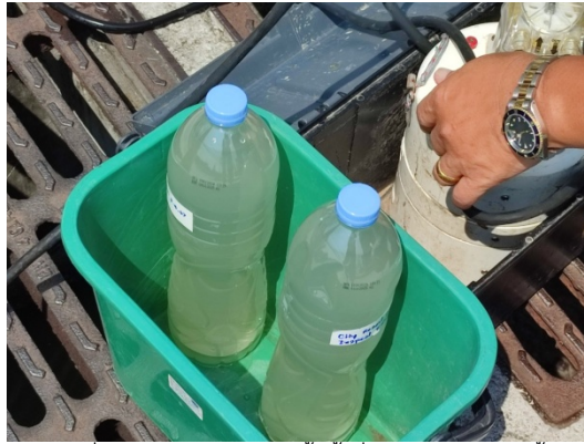
ภาพที่ 3-9 การเก็บตัวอย่างน้ำทิ้งที่ปอดตรวจคุณภาพน้ำ
