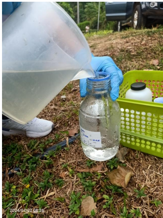
ภาพที่ 22 แสดงการเก็บตัวอย่างน้ำทิ้งไปตรวจวิเคราะห์
