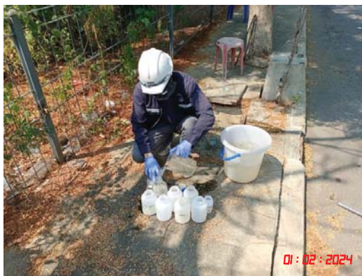
จุดเก็บบ่อพักสุดท้ายก่อนระบายออกนอกโครงการ
