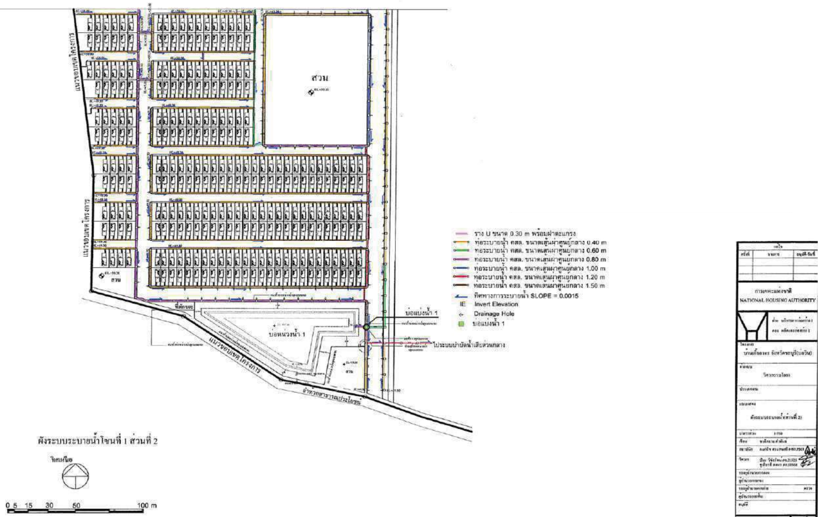
รูปที่ 2-13 ผังแสดงระบบระบายน้ำภายในพื้นที่โครงการ และบ่อหน่วงน้ำของโครงการเคหะชุมชนและบริการชุมชน จังหวัดชลบุรี(บ่อวิน)
