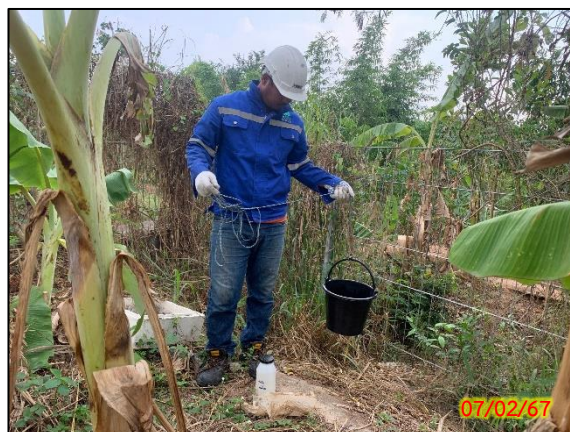
จุดเก็บน้ำทิ้งจากบ่อพักสุดท้ายก่อนระบายออกนอกโครงการ
