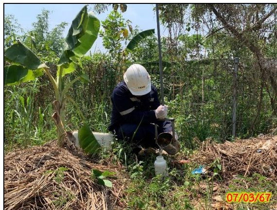
จุดเก็บน้ำทิ้งจากบ่อกักสลายก่อนระบายออกนอกโครงการ
