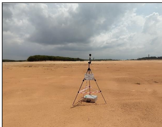
รูปที่ 3.10 ตรวจวัดระดับเสียง 15 นาที บริเวณ เครื่องจักร/เครื่องมือ ซึ่งเป็นแหล่งกำเนิดเสียงในการก่อสร้าง (N6)
