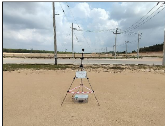
รูปที่ 3.9 ตรวจวัดระดับเสียง 15 นาที บริเวณ เครื่องจักร/เครื่องมือ ซึ่งเป็นแหล่งกำเนิดเสียงในการก่อสร้าง (N5)
