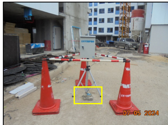
รูปที่ 3.3-1 จุดตรวจวัดความสั่นสะเทือน บริเวณพื้นที่ก่อสร้าง ด้านที่อยู่ใกล้อาคารข้างเคียงมากที่สุด
