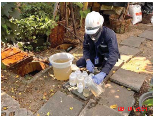
บ่อน้ำเสียก่อนเข้าสู่ระบบบำบัดน้ำเสีย อาคาร 2
