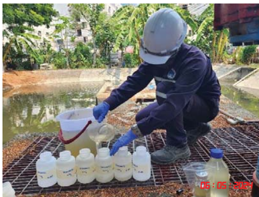
จุดเก็บบ่อบำบัดสุดท้ายก่อนระบายออกสู่แหล่งน้ำสาธารณะ
