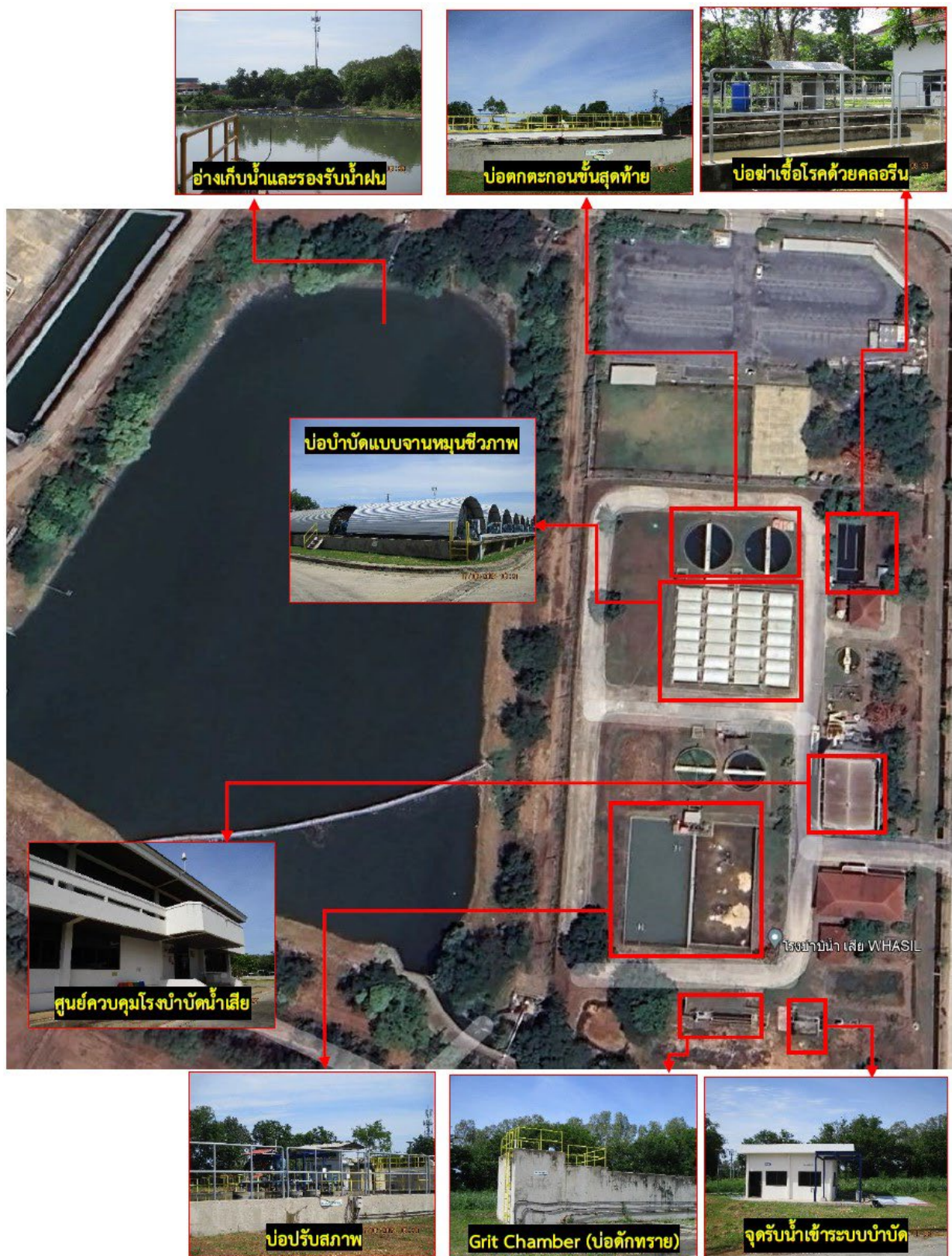
ภาพที่ 2-8 ระบบบำบัดน้ำเสียส่วนกลางทางชีวภาพ
