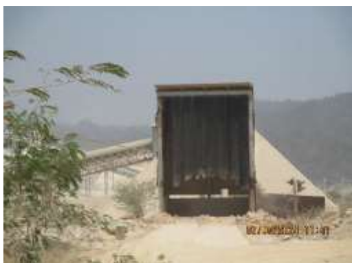
รูปที่ 2-31 เครื่องฉีดพ่นน้ำในลักษณะของม่านน้ำ บริเวณลานกองวัตถุดิบ
