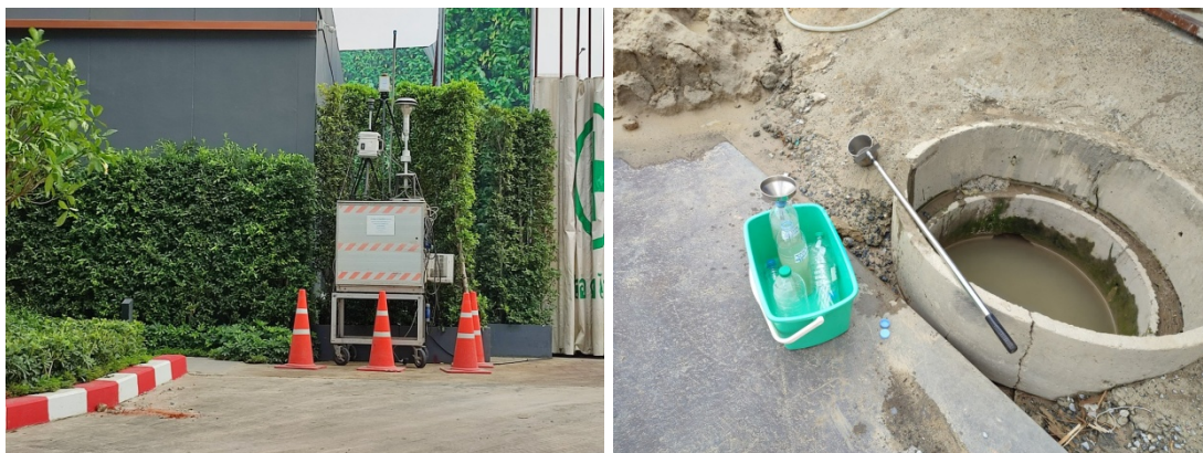
ติดตั้งเครื่องตรวจวัดฝุ่นละออง ก๊าซมลพิษภายในพื้นที่โครงการ CO , NO 2 , SO 2 , THC เครื่องตรวจวัดเสียง และเครื่องวัดแรงสั่นสะเทือน ย้ายไปตามจุดที่มีการทำเสาเข็ม ภายในพื้นที่โครงการ เก็บตัวอย่างน้ำทั้งก่อนระบายออกสู่ท่อระบายน้ำสาธารณะ
