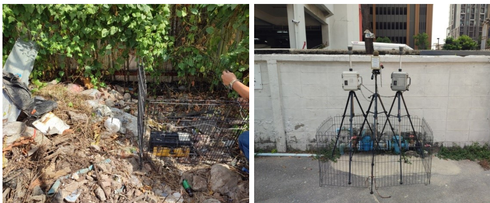
เครื่องวัดความสั่นสะเทือนที่ติดตั้ง และ ติดตั้งเครื่องตรวจวัดฝุ่นละออง เครื่องตรวจวัดเสียง ที่โรงเรียน นิธิปริปัญญา
