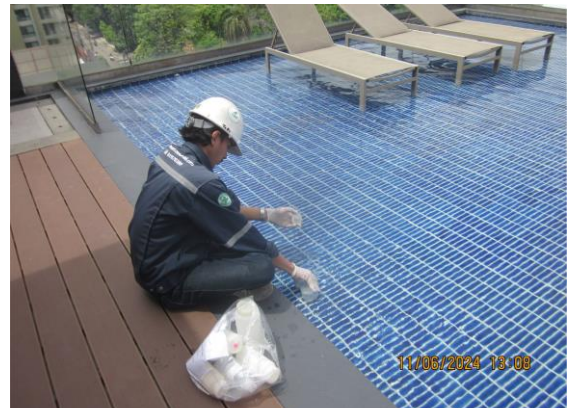
รูปที่ 3-14 การเก็บตัวอย่างคุณภาพน้ำสระว่ายน้ำ บริเวณสระว่ายน้ำส่วนต้น
