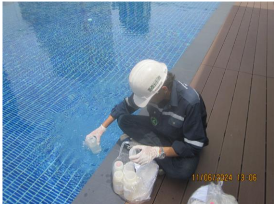
รูปที่ 3-13 การเก็บตัวอย่างคุณภาพน้ำสระว่ายน้ำ บริเวณสระว่ายน้ำส่วนเล็ก
