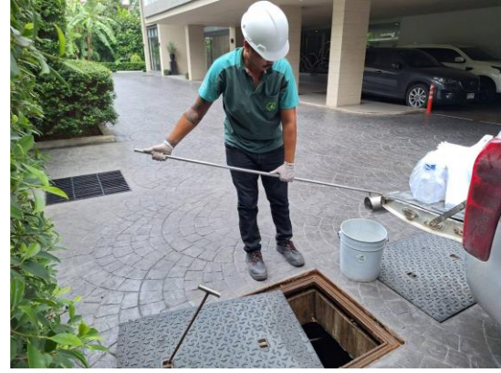
รูปที่ 3-6 การเก็บตัวอย่างคุณภาพน้ำทิ้ง บริเวณบ่อพักน้ำสุดท้ายก่อนระบายออกระบบ ระบายน้ำทิ้งสาธารณะ
