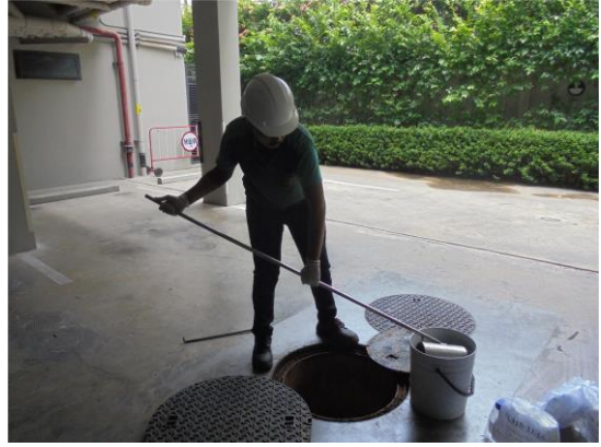
รูปที่ 3-4 การเก็บตัวอย่างคุณภาพน้ำทิ้ง บริเวณน้ำเสียก่อนเข้าระบบ (บ่อที่ 2)
