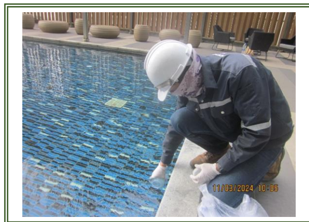
รูปที่ 3-18 การเก็บตัวอย่างคุณภาพน้ำทิ้ง บริเวณบ่อตรวจระบายน้ำของโครงการ
