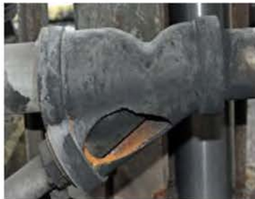
รูปที่ 1 Y-strainer แบบเหล็กหล่อ ติดตั้งอย่างไม่ถูกต้องในท่อสแตน เลสแบบเชื่อม
