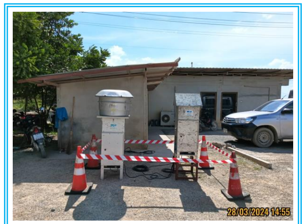
รูปที่ 4.3-4 แสดงการตรวจวัดคุณภาพอากาศ บริเวณโรงโม่หินของโครงการ ระหว่างวันที่ 28-29 มีนาคม 2567
