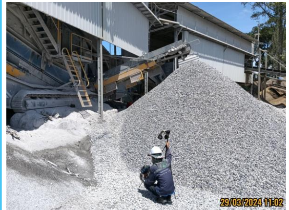
รูปที่ 4.3-8 แสดงการตรวจวัดค่าความทึบของฝุ่นละออง (Opacity) บริเวณตะแกรงคัดขนาดหิน วันที่ 29 มีนาคม 2567
