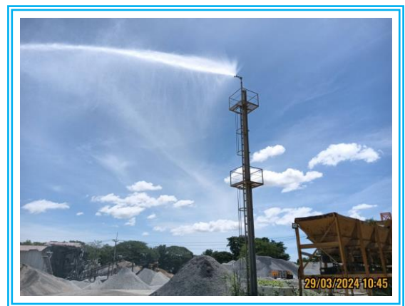
รูปที่ 3-9 สเปรย์น้ำบริเวณที่เกิดฝุ่นละออง
