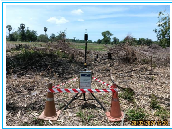
รูปที่ 4.3-12 แสดงการตรวจวัดระดับเสียง บริเวณบ้านร่องไม้แดง ระหว่างวันที่ 28-29 มีนาคม 2567
