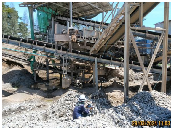
รูปที่ 4.3-9 แสดงการตรวจวัดค่าความทึบของฝุ่นละออง (Opacity) บริเวณจุดถ่ายโอน (Transfer Point) วันที่ 29 มีนาคม 2567
