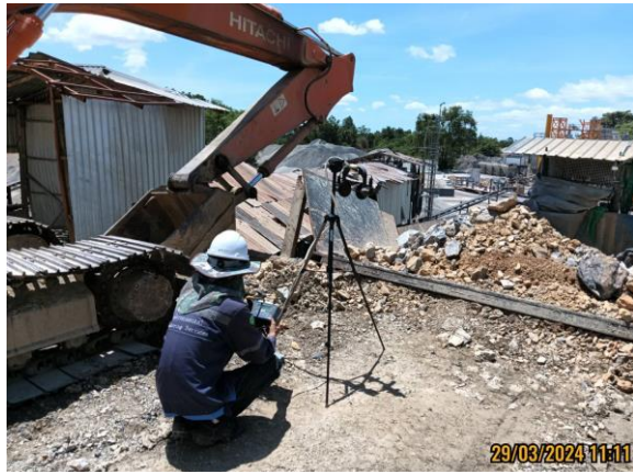
รูปที่ 4.3-7 แสดงการตรวจวัดค่าความทึบของฝุ่นละออง (Opacity) บริเวณบนปากโม (Primary Crusher) วันที่ 29 มีนาคม 2567
