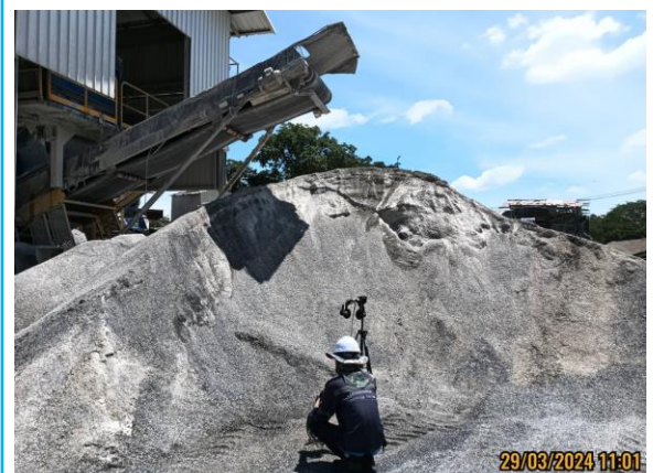
รูปที่ 4.3-10 แสดงการตรวจวัดค่าความทึบของฝุ่นละออง (Opacity) บริเวณปลายสายพานลำเลียง วันที่ 29 มีนาคม 2567
