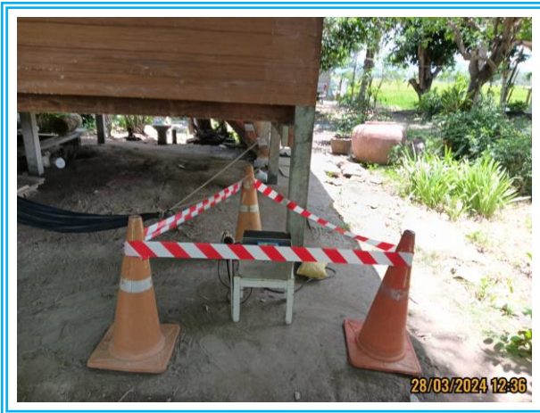
รูปที่ 4.3-18 แสดงการตรวจวัดความสั่นสะเทือน บริเวณบ้านร่องไม้แดง วันที่ 28 มีนาคม 2567
