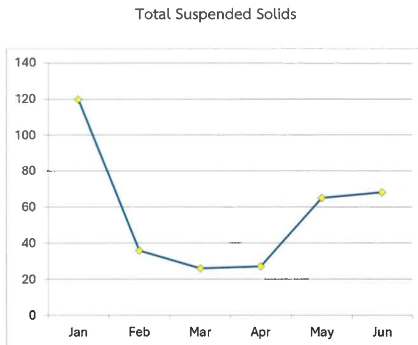
รูปที่ 3-5 แสดงผลการตรวจวัดค่า Total Suspended Solids ของน้ำทิ้งก่อนการบำบัด
