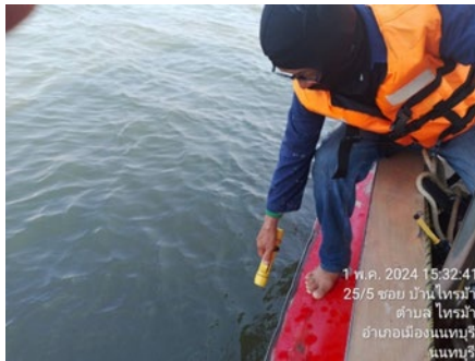
ภาพที่ 3.2.5-4 การตรวจวัดความเร็วและทิศทางการไหลของกระแสน้ำ
