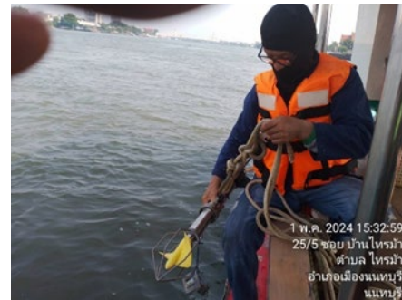
ภาพที่ 3.2.5-4 การตรวจวัดความเร็วและทิศทางการไหลของกระแสน้ำ
