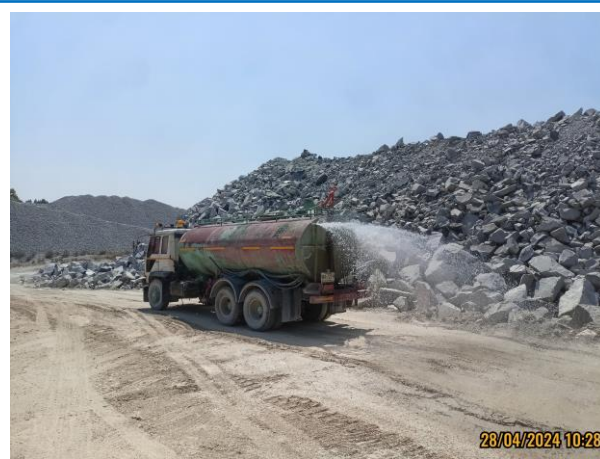
รูปที่ 3-14 การฉีดพรมน้ำบนเส้นทางขนส่งแร่
