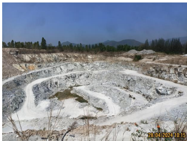
รูปที่ 3-9 พื้นที่หน้าเหมืองลักษณะขั้นบันได (Benching Method)
