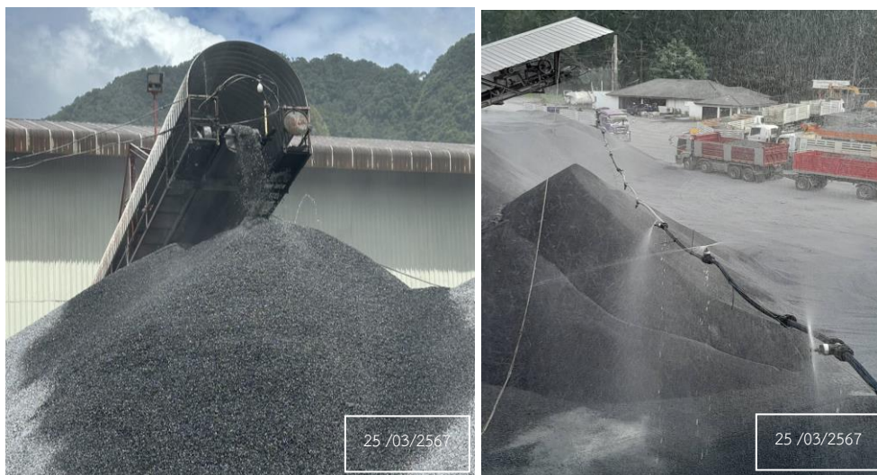
ภาพที่ 2-9 ระบบสเปรย์น้ำบริเวณปลายสายพานลำเลียงและมีระบบปิดคลุม
