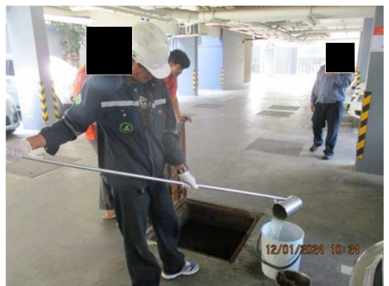
รูปที่ 3-7 ภาพน้ำทิ้งหลังการบำบัด บริเวณท่อสูบน้ำทิ้งระบบบำบัดน้ำเสียอาคาร C
