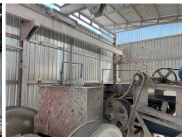
รูปที่ 2-23ก. โรงโม่หินที่เป็นระบบปิด และมีการติดตั้งระบบสเปรย์น้ำ
