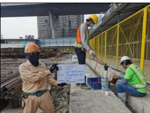
ภาพที่ 45 การตรวจวัดการเคลื่อนตัวของดิน (Inclinometer)
