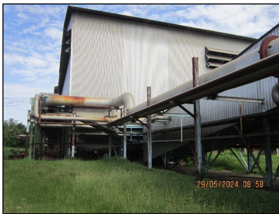
ภาพที่ 2.2-9 ระบบสายพานลำเลียงแบบปิด
