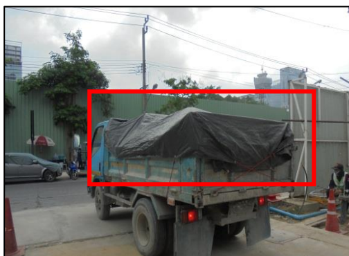
รูปที่ 31 การคลุมรถบรรทุกที่ใช้ขนส่งวัสดุก่อสร้าง ด้วยผ้าใบอย่างมิดชิด
